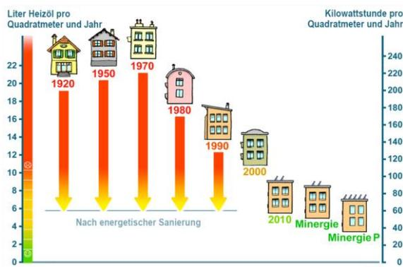
Abbildung 5: Typische Energiekennzahlen und Einsparpotentiale für den Wärmebedarf nach Gebäudebaujahr
